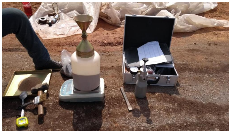
Figura 3.25: Ensaio do frasco do frasco e método do speedy para obtenção da umidade.
